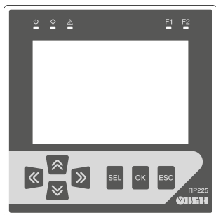
Рисунок 15 – Лицевая панель прибора (крышка справа показана в открытом положении)
