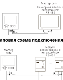
Рисунок 14 – Типовая схема подключения в режиме Master
